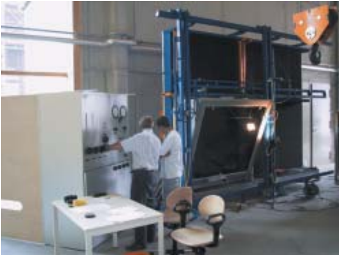
Fenster- und Fassadenprüfstand
