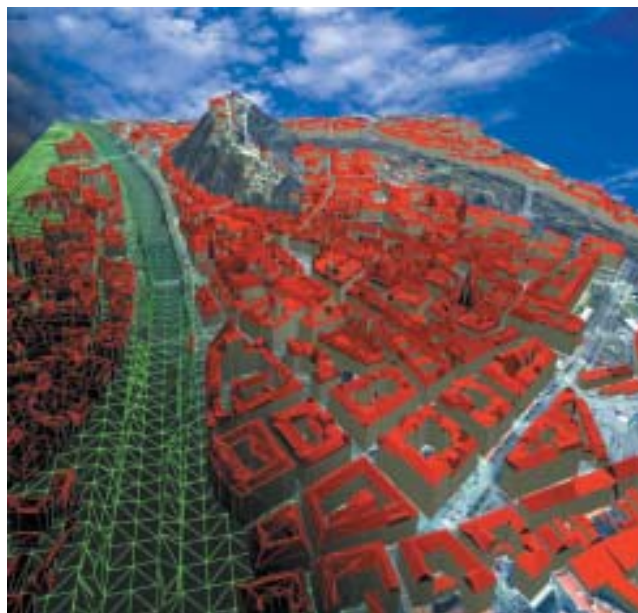
3D Stadtmodell Graz: aus Geometriedaten (siehe Dreiecksmaschen links) wird Fotorealismus durch Überlagerung mit fotografischer Textur (rechts)
