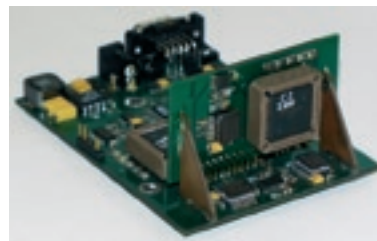
Abb.1: Ein neuer Inertialsensor (Eigenentwicklung) bestehend aus drei Beschleunigungs- und drei Drehratensensoren kann zur Messung aller sechs Freiheitsgrade der Position und Orientierung eingesetzt werden.
