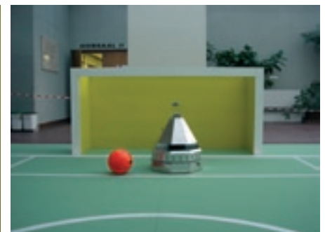
Abb. 6: (a) Autonome Fussballroboter „Keksi“ des Teams der TU Graz für die Roboter-Fussball-Weltmeisterschaft RoboCup. (b) Detail des Bildverarbeitungs-Sensors (360 Grad Panorama). (c) RoboCup Spielfeld im Foyer der Inffeldgasse 18.
