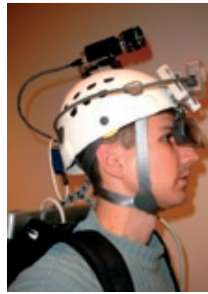
Abb.5: Mobiles AR-System bestehend aus Helm mit Datenbrille und Tracking Sensoren, und Rucksack mit zwei Computersystemen (single-board computer für Tracking, Laptop für 3D Graphik). (a) Gesamtsystem in Verwendung. (b) Rucksack. (c) Helm.
