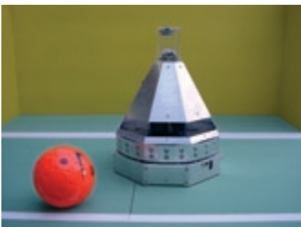
Abb. 6: (a) Autonome Fussballroboter „Keksi“ des Teams der TU Graz für die Roboter-Fussball-Weltmeisterschaft RoboCup. (b) Detail des Bildverarbeitungs-Sensors (360 Grad Panorama). (c) RoboCup Spielfeld im Foyer der Inffeldgasse 18.
