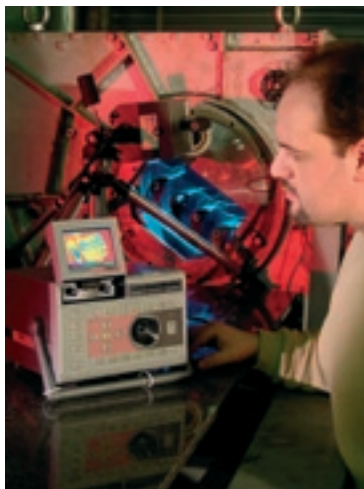
Optimierung der Kühlung moderner Turbinenschaufeln im Überschallwindkanal (Quelle: TTM TU Graz)
