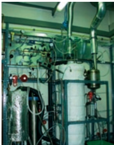
Laborversuchsanlage zur Reformierung von Erd- bzw. Biogas für Brennstoffzellen-Blockheizkraftwerke (Quelle: IWT TU Graz)
