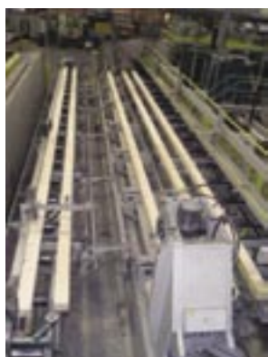
In den Produktionsprozess integrierte ‚proof loading‘-Anlage
