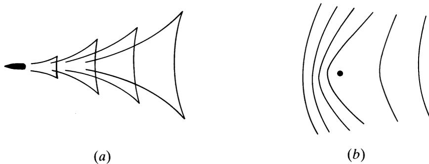
Abbildung 9.2: Stationäres Wellenbild in der Strömung (a) vorbei an einem Schiff, (b) vorbei an einer Angelleine.
