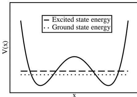
Betrachten Sie das abgebildete Doppelmuldenpotential  $V(x)$ . In der Abbildung ist bereits die Energie des Grund- und der ersten angeregten Zustands angedeutet. Das Potential  $V(x)$  sei an  $x = 0$  zentriert.
