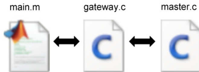
Abbildung 1: Informationsfluss zwischen MatLab ( main.m ) und dem Unterprogramm ( master.c )
