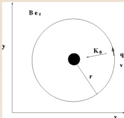
Wenn die Geschwindigkeit des Elektrons  $v$  ist, dann ist die gesamte Zentripetalkraft  $K$  (gegeben durch die anziehende Kraft des Kernes  $K_0$  und die des  $B$ -Feldes)
