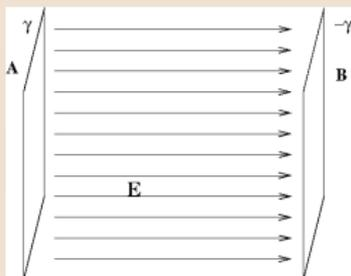
Das Potential zwischen den Ebenen wird bestimmt durch  $\nabla\phi(\mathbf{r}) = -\mathbf{E} \Rightarrow \phi(\mathbf{r}) = -\mathbf{E} \cdot \mathbf{r}$ . Die Potentialdifferenz (Spannung) zwischen den beiden Ebenen ist also  $V = \phi(A) - \phi(B) = E d$ , wo  $d$  der Abstand zwischen den Ebenen ist.
